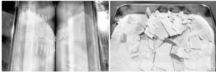
写真1 ロール表面に発生した付着とフレック状剥離物
