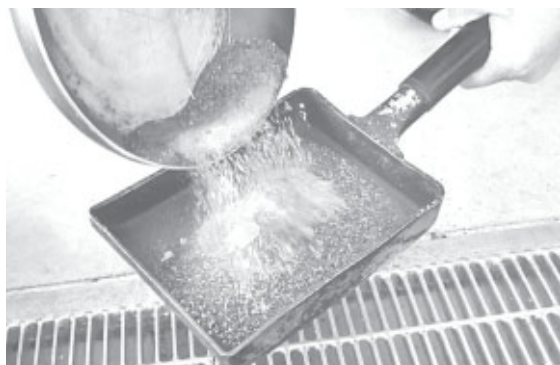
写真-2 Nd合金粉末の酸化燃焼
