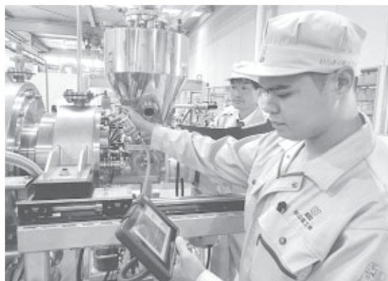
写真-12 Heリークディテクターによる漏れ検査
