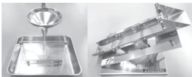
写真-3 自社製測定器（左：注入安息角 右：流動評価）
