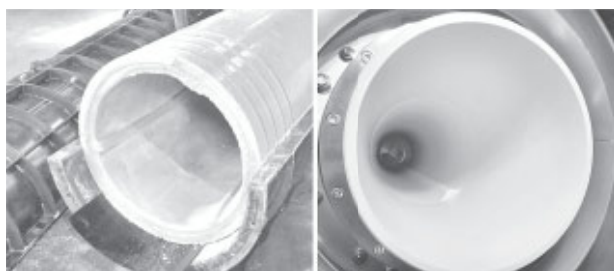
写真-11 セラミックレトルト (左：鋳込み 右：CIP)
