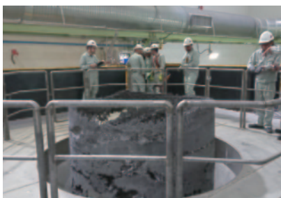
航空機エンジンの材料であるスポンジチタン。この生成技術があるのは国内で2社のみ
