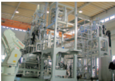
リチウムイオン電池陽極材の計量粉碎設備。次世代自動車向けにニーズが高まっています
